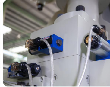
03 控制程序与油路精确配合实现开模位置可调，开模定位平稳，重复定位精度小于3mm，效率提升5~10%。
