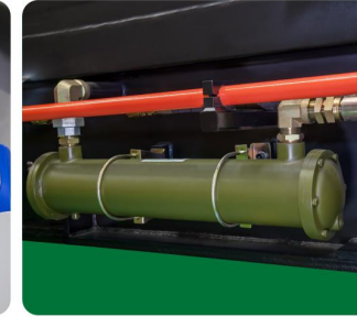
04 始创定制的冷却器，油温低3~5℃，油温控制效果显著。
