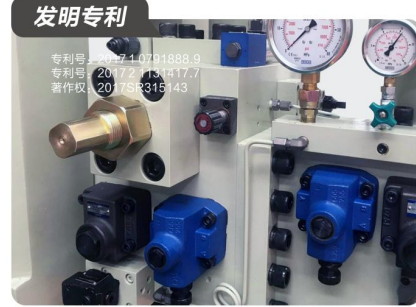
02 发明专利技术的快压射截止机构，建压时间短且稳定。(GDC系列)
