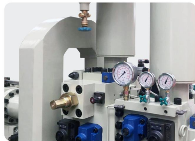
01 具有自动平衡压力的快压射储能器，进一步调整气-液容积比和活塞速度，减少压降，消除压力波动，提升铸件致密性。
